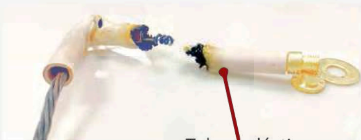
Tubos plásticos SIN fibra vulcanizada
